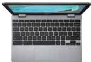
\* 防滴性の確認として、66ccの液体をキーボード上に注ぎ、その後逆さにして脱水し24時間後(水は72時間後)、テストを実施しています。水、コーヒー、コーラにて3回、実施しその後の正常動作を確認しています。本製品の防滴性能は、無破損・無故障を保証するものではありません。あらかじめご了承ください。
