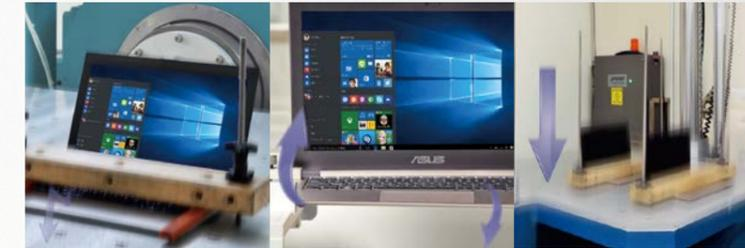
> 開閉テスト > 加圧テスト > 落下テスト
