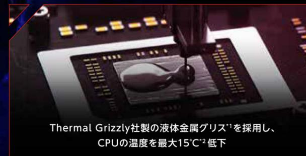
Thermal Grizzly社製の液体金属グリス<sup>1)</sup>を採用し、CPUの温度を最大15°C<sup>2)</sup>低下
