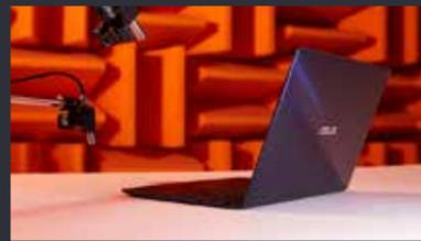
すべてのASUSノートPCのオーディオシステムを設計しているASUS Golden Earチームでは、最高のサウンドの実現をめざし、ASUS専用のISO 7779に準拠した音響テスト施設で、ファンなどからのノイズを最小限に抑えるため徹底したノイズテストを行っています。
