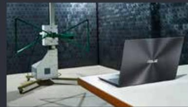
他の電子機器への干渉を抑え、また、外部からの電磁波の干渉に耐えられるよう、徹底したEMI(電波障害)テストを行っています。また、一部のモデルではさまざまな環境においてもWi-Fi範囲と性能を最適化する独自の技術「ASUS Wi-Fi Master テクノロジー」も搭載されています。
