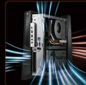
[3方向から外気を吸気するエアフロー構成]
