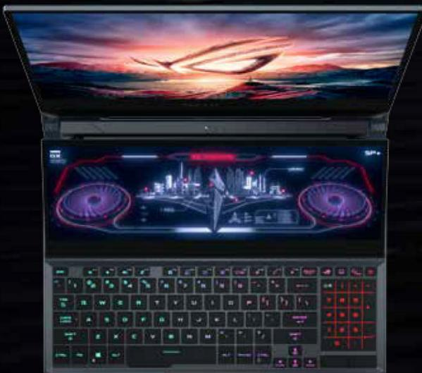
メインディスプレイのほかに、14型で3,840×1,100ドット表示のScreenPad™ Plusディスプレイを搭載。メインディスプレイでゲームをプレイしながら、ゲーム配信やチャットなどのウィンドウを、ゲーム画面とは別に表示することができます。ScreenPad™ Plusの画面は、天板を開くことで手前に13度持ち上がるヒンジ構造を採用。見やすいだけでなく、タッチスクリーンなので操作も快適です。
